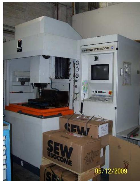
Máq. De erosión por penetración
